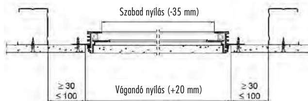
Beépítési vázlat csapóvíz esetén
