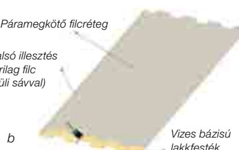
4. ábra: A filces lemezek végein a kapilláris vízfelszívódás megakadályozása (a) helyszínen égetéssel vagy (b) vizes bázisú lakkfestéssel
