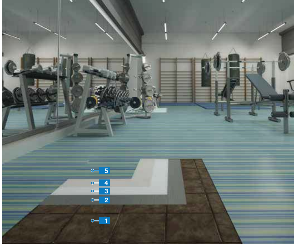
PVC fektetése régi kerámia burkolatra
