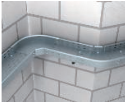
Sarokidom szerelése 100 - 300 mm tálcaszélességig A 100-300 mm széles sarokidomok kialakítása olyan, hogy az előtte és utána következő tálcához összekötő nélkül csatlakoztatható. Az elvárt stabilitás a keresztidom közvetlen környezetében beépített alátámasztásokkal biztosítható.
