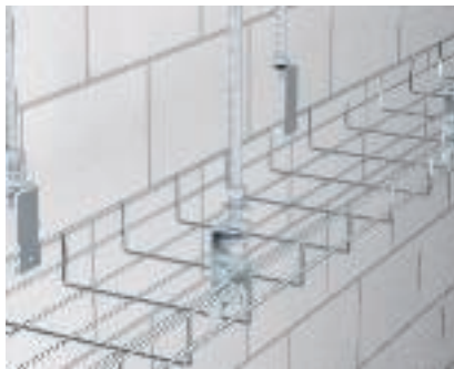
Felfüggesztés oldalfüggesztővel Rácsos kábeltálca felfüggesztése SH M10 típusú oldalfüggesztőkkel és 2078/M10 típusú menetes szárrakkal.
