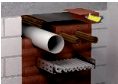
Éghető anyagú csövek átvezetése, kiegészítő intézkedések nélkül
