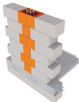
Függőleges zsaluzatként, téglakötésben
