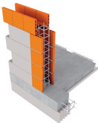
Függőleges zsaluzatként, téglakötés nélkül, illetve vízszintes zsaluzatként koszorúhoz
