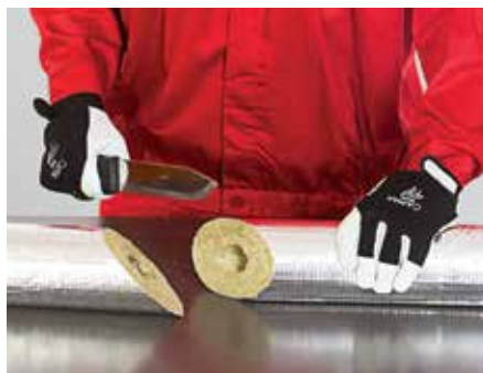
5. kép – A csőhéjat két 45°-os elemre vágjuk
