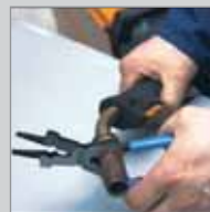
fúvóka eltávolítása és rögzítése
